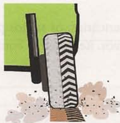
Se a cambagem for negativa, o pneu gastará mais do lado de dentro.
