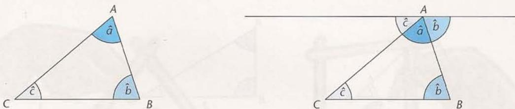
Escolhemos o vértice A e, por ele, traçamos uma reta paralela à base BC. Comparando com a figura que vimos na aula passada, de duas retas paralelas cortadas por uma transversal, vemos que os ângulos ao lado de **a** são iguais a **b** e **c**. Primeiro, a transversal é AB, e, portanto, o ângulo à direita de **a** é igual a **b**; e, depois, a transversal é AC, e o ângulo à esquerda de **a** é igual a **c**.
